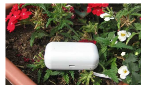
einfacher Feuchtesensor auf Leitfähigkeitsbasis
