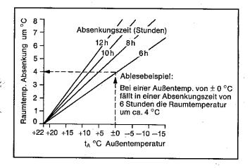
Durchschnittliche Zeit, in der die abgesenkte Raumtemperatur in Abhängigkeit der Außentemperatur bei normal isoliertem Haus wirksam wird.
